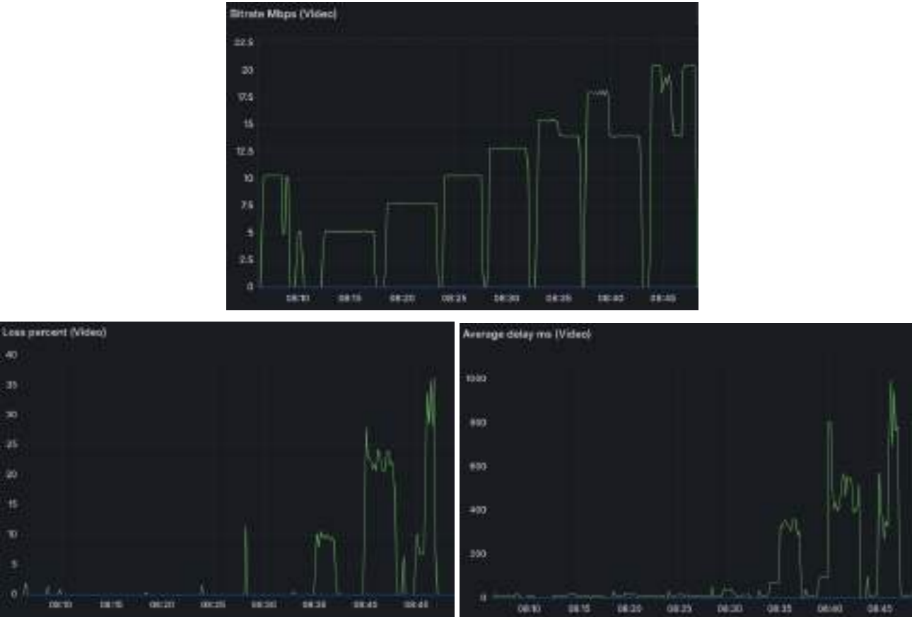
Fig. 3.19. Medidas en el backend: bit rate de video (recibido), tasa de pérdida de paquetes y retardo medio en de paquete (one-way)
