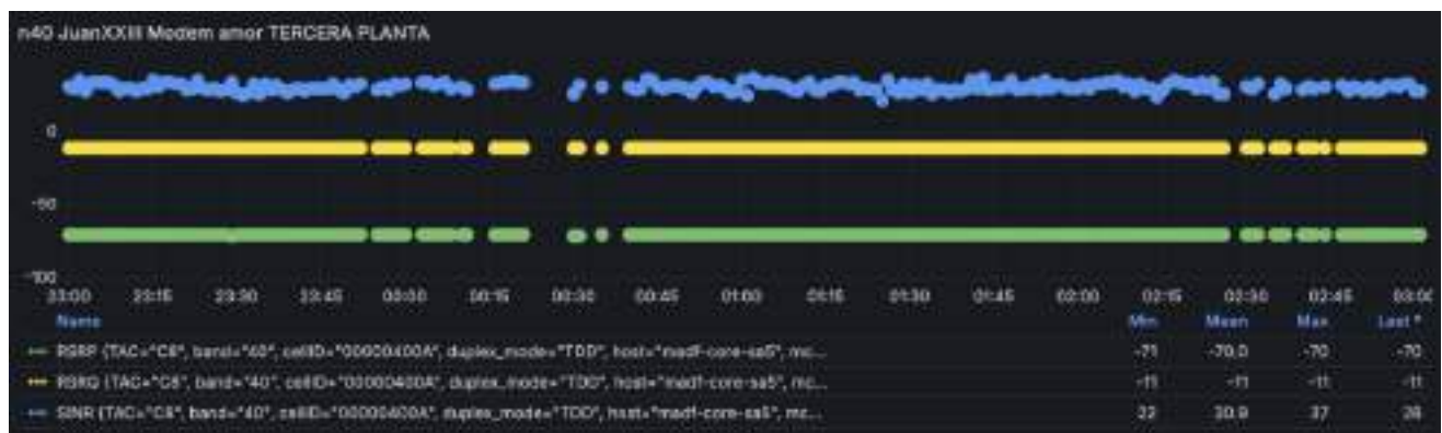
Fig. 2.16. Detalle de la calidad de señal del módem en posición 1 (despachos tercera planta) durante las pruebas de estabilidad
