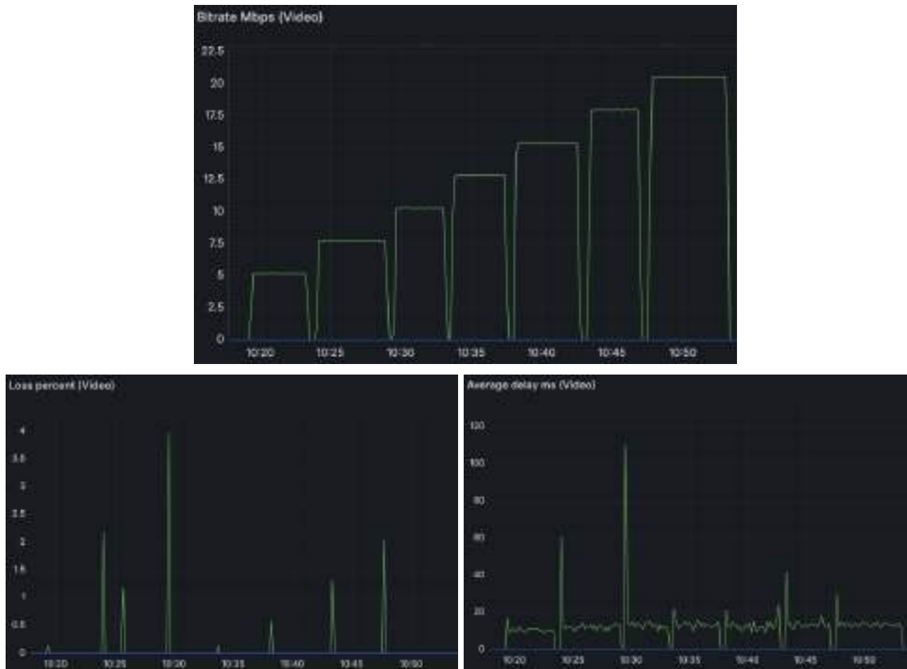
Fig. 3.21. Medidas en el backend: bit rate de video (recibido), tasa de pérdida de paquetes y retardo medio en de paquete (one-way)
