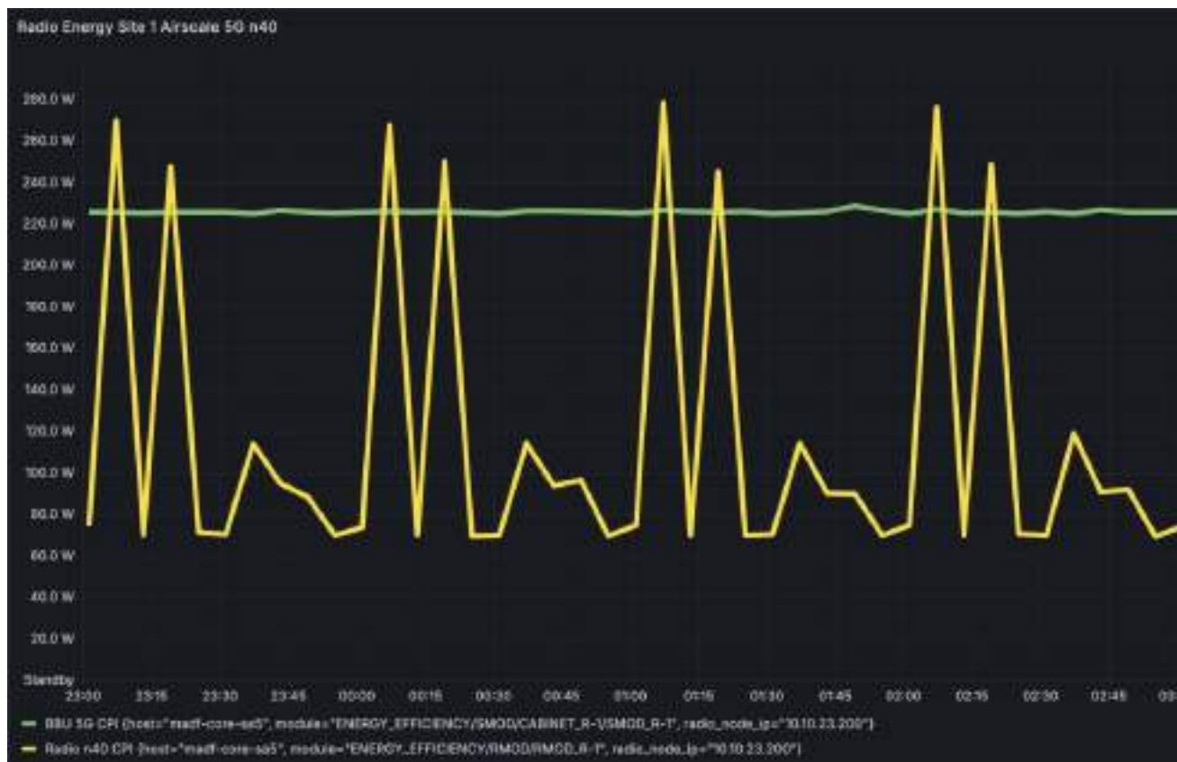
Fig. 2.17. Detalle del consumo de energía en banda base (verde) y RRH (amarillo) durante las pruebas de estabilidad
