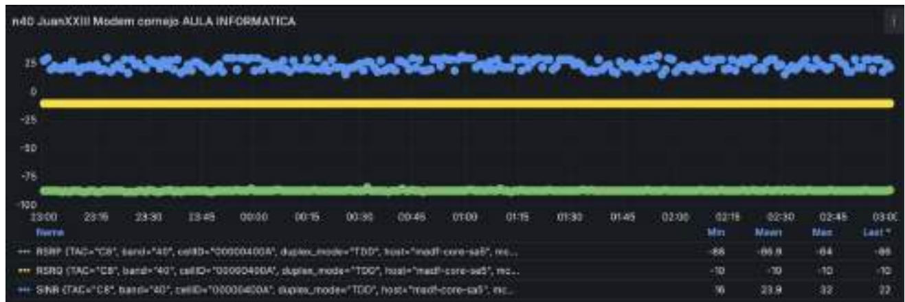
Fig. 2.15. Detalle de la calidad de señal del módem en posición 5 (aula de informática) durante las pruebas de estabilidad
