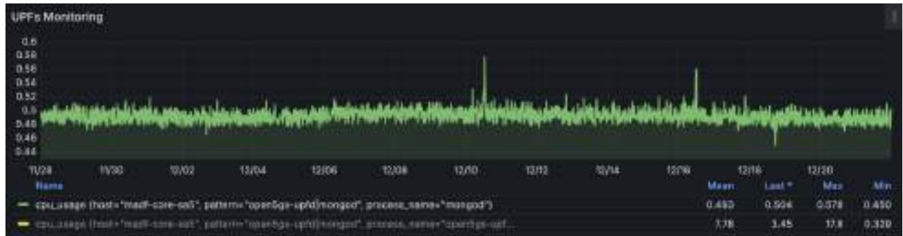
Fig. 2.9. Monitorización de la carga de CPU del core durante las pruebas de estabilidad
