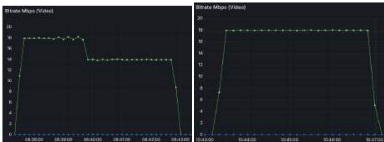
Fig. 3.23. Comparación del bit rate recibido sin (izquierda) o con (derecha) el slicing activo
