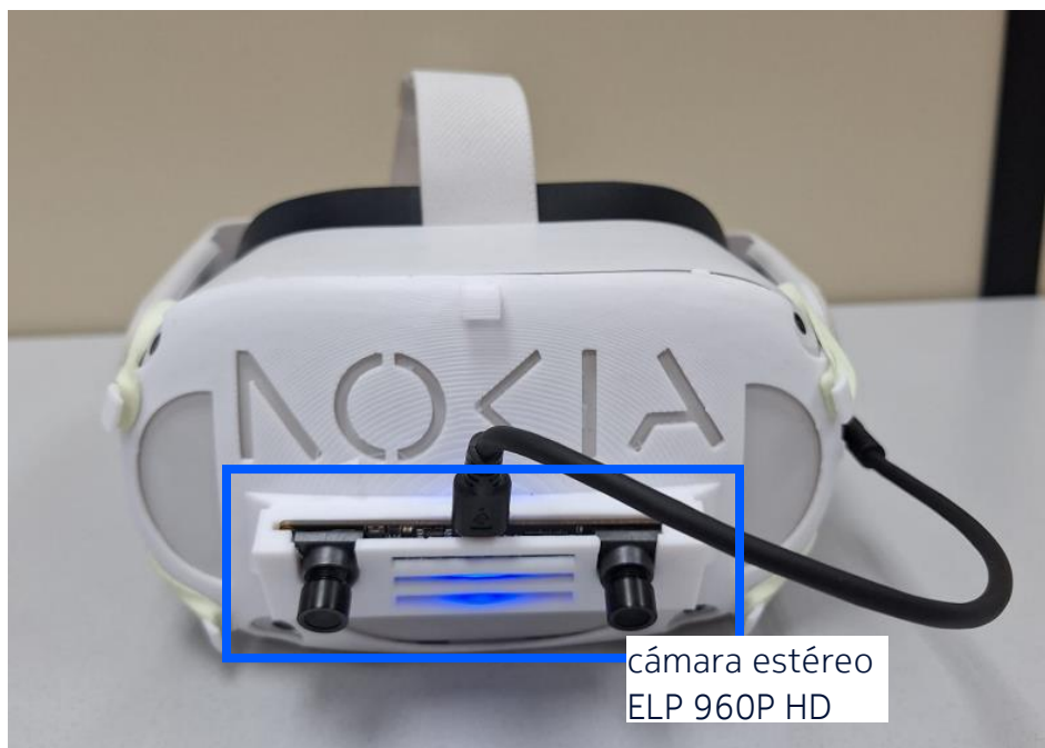
Figura 4: Meta Quest 2 (HMD) + cámara estéreo ELP 960P HD
