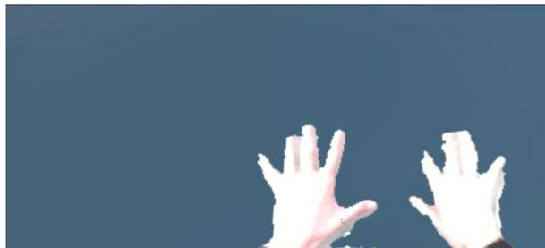
Figura 4: Ejemplo de cómo una persona con las gafas de RV puede observar sus propias manos gracias al algoritmo de segmentación
